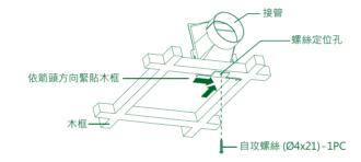
3 將機體風口位置對準接管位置安裝在木框內,並將機體與接管溝槽緊密結合。
