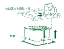
4 用Ø4x21自攻螺絲4顆牢固地將機體2邊以對角方式鎖附於木框上。 (使用電動起子鎖附力<8kg-m)
