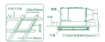
2 先將排風管連接於接管,在連接處使用膠帶或填補劑固定與氣密。 將接管緊貼木框,使用附屬之自攻螺絲1顆,將接管安裝於木框上。
