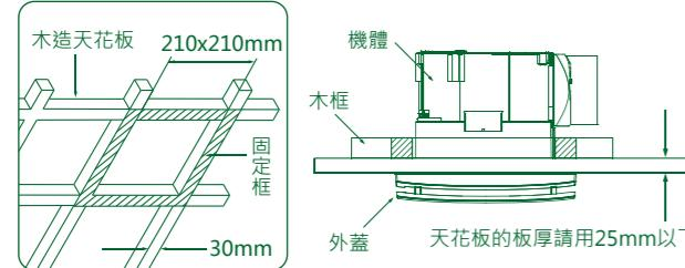
3 將機體風口位置對準接管位置安裝在木框內，並將機體與接管溝槽緊密結合。
