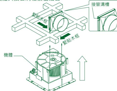
2 先將排風管連接於接管，在連接處使用膠帶或填補劑固定與氣密。
