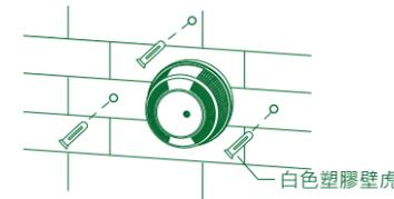
3. 再次套上導流型防雨罩，對準螺絲孔位置，使用附件內的安裝螺絲釘將其固定在牆上的塑膠壁虎中。
