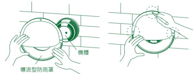
2. 取下防雨罩，在螺絲孔瞄點位置絞孔 Ø6mm 深度30mm 以上，然後打入白色塑膠壁虎。
