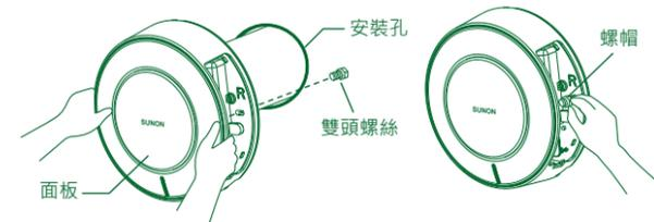
5. 正確安裝時，管道向室外傾斜角度為1度。
