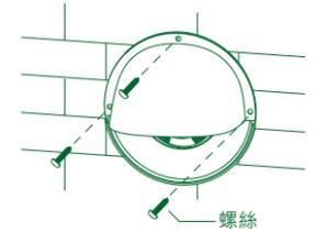
4. 沿著導流型防雨罩的邊緣用防水材料密封，避免雨水滲入室內。
